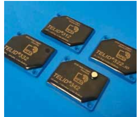
TELID®3X2 – RFID Sensor Datenlogger im Halbcheckkartenformat
