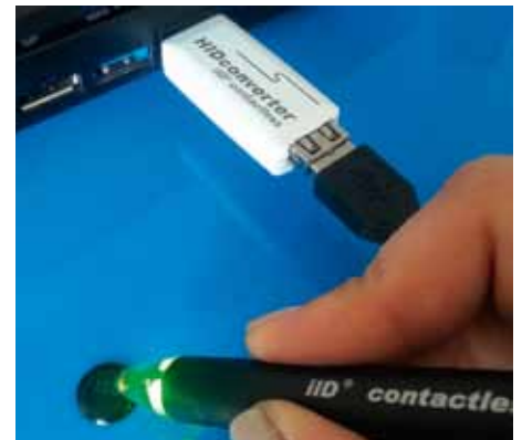
iID®PENmini mit HIDconverter – Wenn RFID Reader zu einer Tastatur werden
