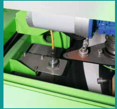
Der RFID-Schreiblesekopf erkennt die Tags im Boden zuverlässig.
