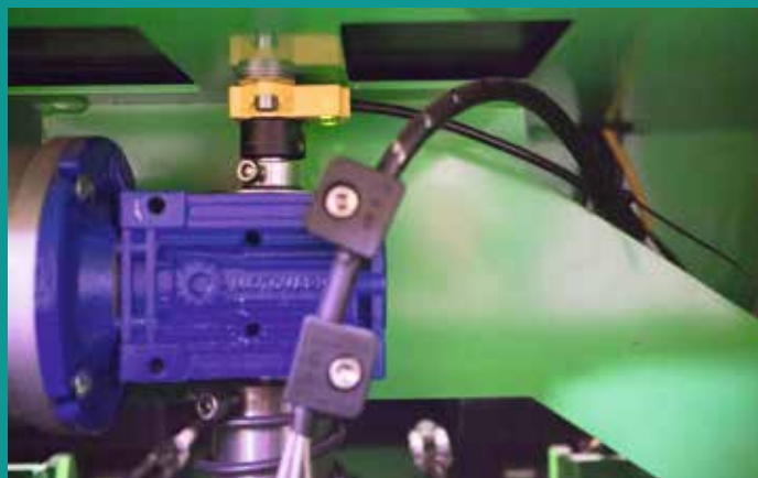
Am Motor der Lenkung erkennt Turcks berührungsloser Winkelgeber den Einschlag der Lenkung.
