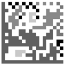
Bild 8: Schlechte Modulation durch ungleichmäßige Schwärzung
