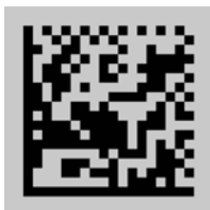
Bild 6: Niedriger Kontrast wegen grauem Trägermaterial
