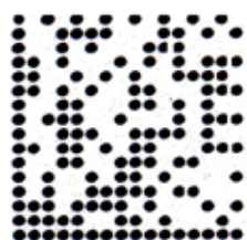
Bild 4: Dot Data Matrix nicht ISO Konform
