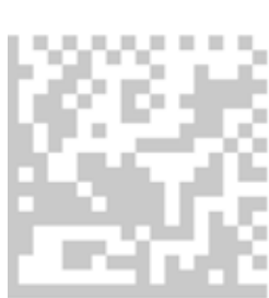
Bild 5: Niedriger Kontrast wegen geringer Schwärzung
