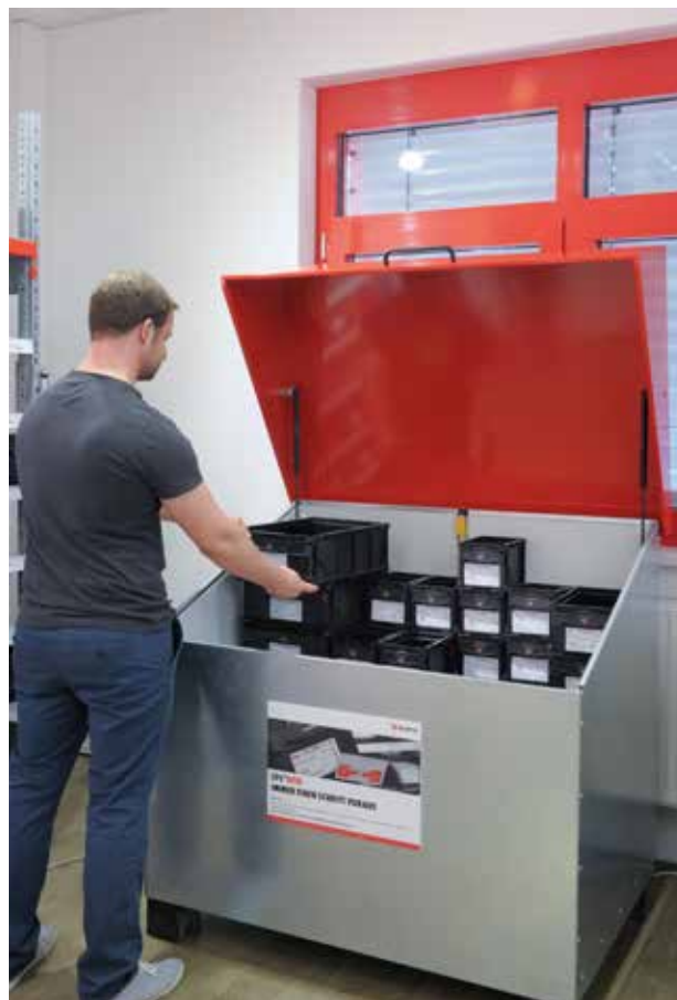
Würth Industrie Services bietet eine RFID-gestützte Kanban-Box zur automatischen Nachlieferung von Teilen an.
