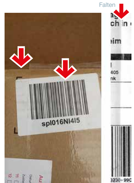
Abb. 6: Umwelt – Unerwartete Leseergebnisse durch Folien, Falten, Knicke, Ecken, durchscheinendes Etikettenmaterial
