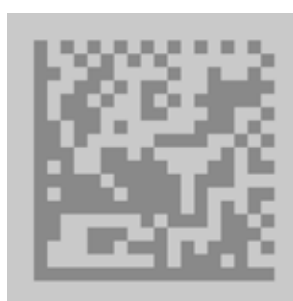
Bild 7: Sehr niedriger Kontrast wegen geringer Schwärzung und dunklem Trägermaterial
