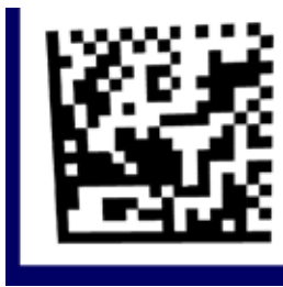
Bild 13: Verzerrtes Symbol mit einer Gitterungleichmäßigkeit
