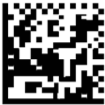
Bild 10: Schlechte Modulation durch Druckungenauigkeit
