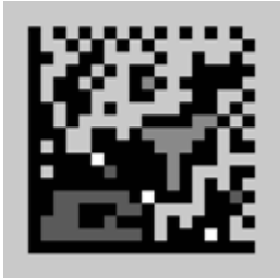
Bild 9: Schlechte Modulation durch ungleichmäßig helles Trägermaterial
