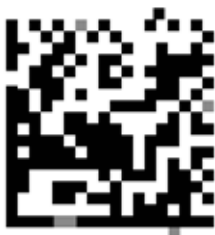
Bild 19: Beschädigte feste Muster
