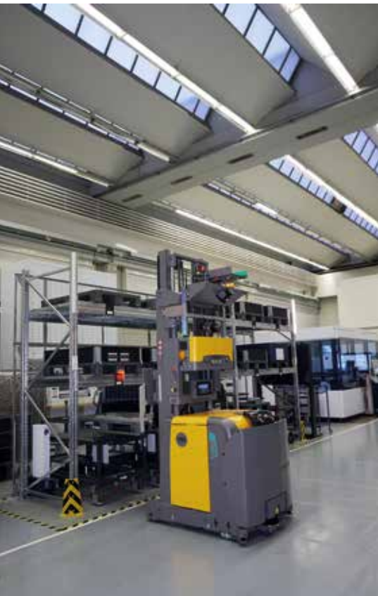
Ein FTS bei der Arbeit – das fahrerlose Transportsystem bestückt eine Docking-Station mit Material.
