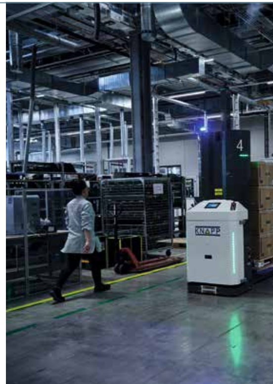
Die Open Shuttle Fork, autonome mobile Roboter für den Palettentransport, automatisieren die Produktionsversorgung und den innerbetrieblichen Transport von Fronius. (© KNAPP)
