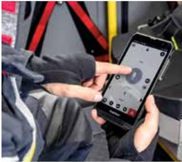
Die leistungsfähige Snapdragon 680 4G Mobile-Plattform unterstützt die optimale Übertragung von Sprach-, Video- und Dateninformationen - wichtig für den sicherheitskritischen Einsatz. Das R&D-Team von RugGear hat durch ein spezielles, innovatives Design eine optimale Audioqualität des 103-dB-Lautsprechers geschaffen. Auch wenn das Gerät im Einsatz mit dem Bildschirm in Richtung Körper getragen wird, ist in lauten Umgebungen eine sehr gute Audio-Übertragung möglich.
