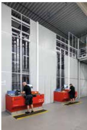
Das neuinstallierte System in Lindenstruth hat eine Lagerkapazität von circa 13.400 Behältern. Diese sind zudem in weitere Fächer unterteilt, sodass sie unterschiedliche Artikel aufnehmen können. Auf der Oberfläche fahren neun mobile Roboter, die automatisch auf die Behälter zugreifen, sobald die darin enthaltene Ware angefordert wird. Anschließend befördern sie die Artikel selbsttätig zu den Ports der Kommissionierstationen.
