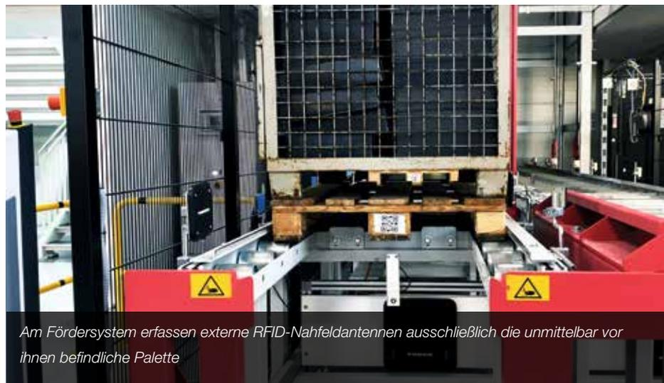
Am Fördersystem erfassen externe RFID-Nahfeldantennen ausschließlich die unmittelbar vor ihnen befindliche Palette
