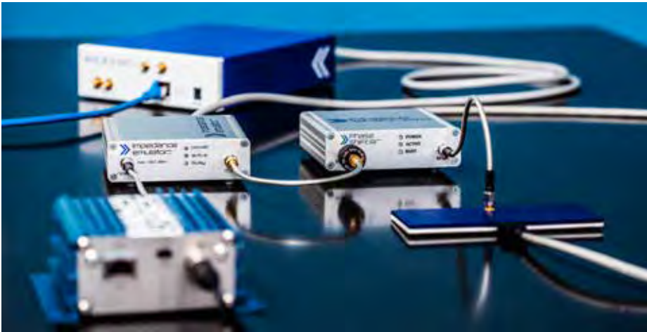
Performanztestergebnisse und Testsetup mit Tag Emulation, Phasenvariation und Impedance Emulation nach ISO/IEC 18046-2 / RAIN RFID
