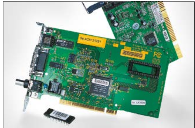
Sichere Kennzeichnung von Bauteilen und Leiterplatten mit Helatag-Thermotransferetiketten.
