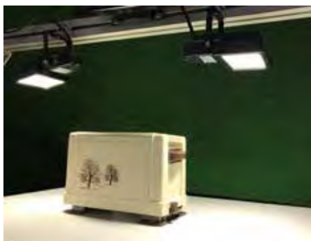
Versuchsaufbau zur Identifikation von Elektro(nik)altgeräten
