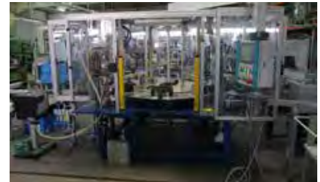
Montageanlage mit acht Stationen. Die Position der Werkstückträger auf dem Montageteiler wird mittels RFID überwacht.
