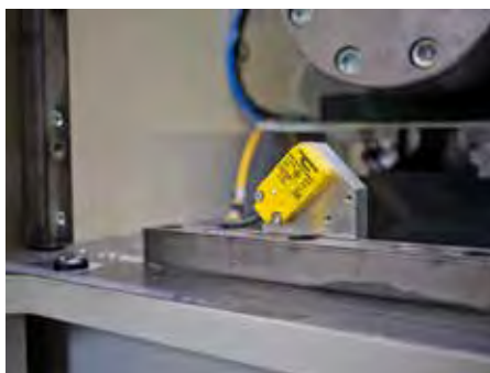
Der RFID-Schreiblesekopf TN-Q14 in IP67 überzeugte mit seiner kompakten Bauform.
