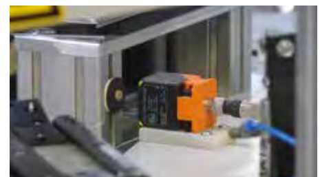
Jeder der münzgroßen RFID-Transponder besitzt eine einmalige Seriennummer (UID). Darüber hinaus lässt er sich frei beschreiben. Bis zu 16 kBit Daten sind möglich.
