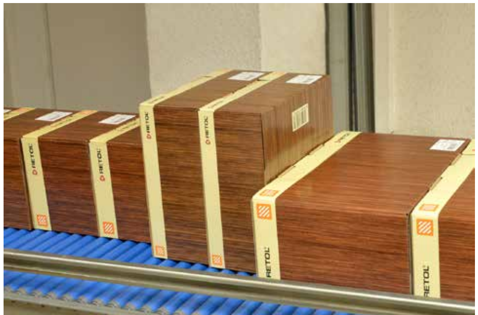
Der Druckspender Legi-Air 4050 E mit Hubsensor etikettiert unterschiedlich hohe Kartons. Die Etiketten haben immer den gleichen Abstand zur Kartonkante.
