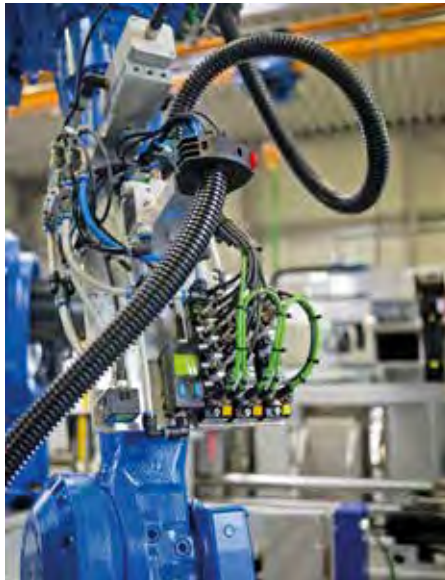
Die ultrakompakten Profinet-TBEN-S-Module am Roboter geben neben digitalen Signalen auch Analogwerte an das Pneumatikventil weiter.
