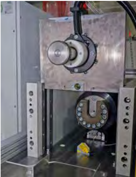
Der Datenträger TW-R30 oben am Werkzeug lässt sich auch zuverlässig lesen, wenn er auf Metall montiert ist.
