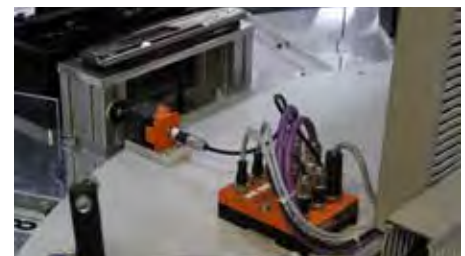
Die Antennenanschlüsse der Auswerteeinheit DTE100 lassen sich auch als Profibus-I/O-Ports für binäre Sensoren und Aktoren nutzen.
