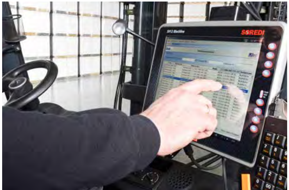
Panzerglas schützt eine extrem helle, kontrastreiche Bildschirmanzeige mit darunter liegendem, kapazitivem Touch Panel.
