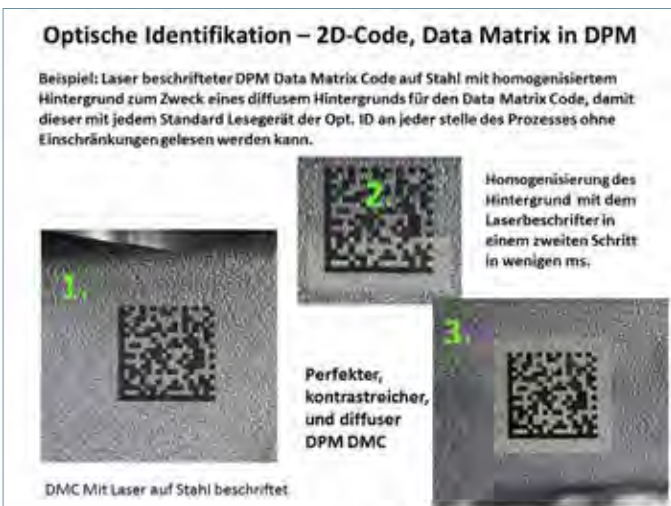
Bild 6: DPM DMC mit homogenisiertem Hintergrund mit diffusem Ergebnis für die Lesung mit jedem Standard Lesegerät der Opt. ID.
