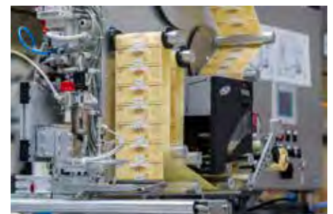
Das REA LABEL Oberbahn- Druckspendensystem verarbeitet unterschiedliche Etikettenformate.
