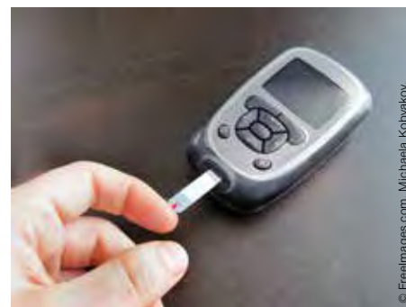
Sensoren in Teststreifen, mit denen Diabetiker ihren Blutzucker messen können
