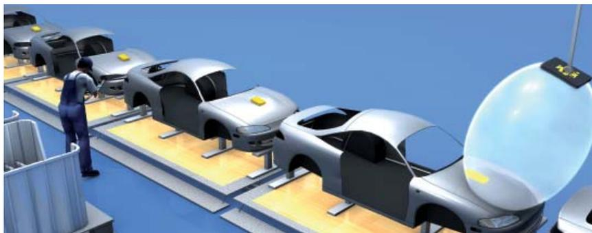
Realisierbar sind Schreib-/Leseabstände von mehreren Metern, auch wenn der Datenträger in Bewegung ist („on the fly“). Die Datenträger sind nahezu unbegrenzt wiederbeschreibbar (EEPROM:  $10^4$  bzw.  $10^5$ ). Schließen Sie UHF-RFID über die Interfacegeräte an Feldbusstandards wie PROFIBUS-DP, EtherNet/IP™, Modbus TCP, DeviceNet™, PROFINET IO und CANopen an.
