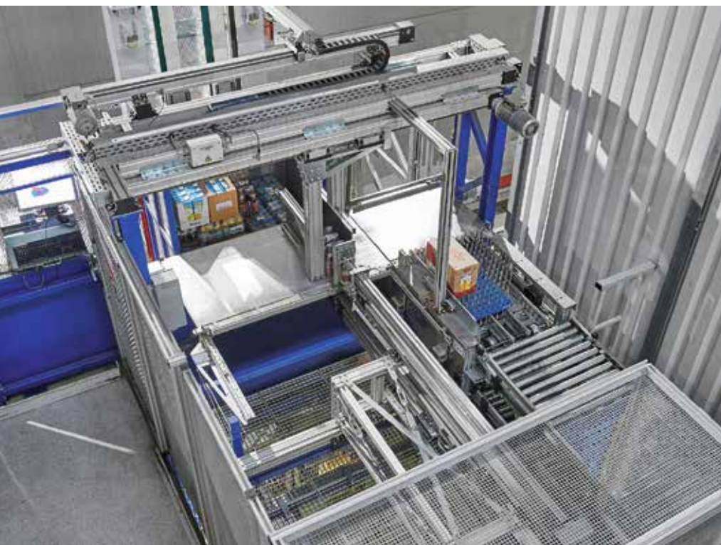
16 Case Order Machines (COM) schichten an einem Spitzentag bis zu 137.000 Handelseinheiten filialgerecht auf Paletten.
