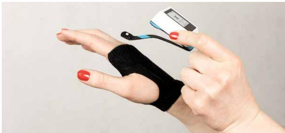
Zahlreiche Barcodetypen können eingestellt werden. Das Aufladen des Scanners erfolgt kontaktlos nach Qi-Standard. Der Handrücken-scanner ist geschützt gegen Staub und Feuchtigkeit (bis IP65).
