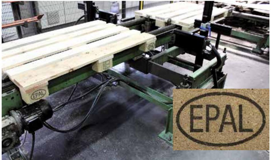
Das direkte Bedrucken von Paletten bietet Kunden im Vergleich zur Verwendung herkömmlicher Brennstempel viele Vorteile:
