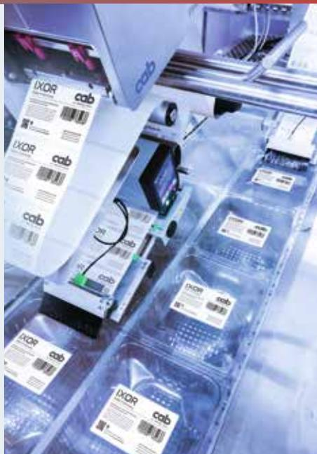
Der Servomotor hält mit jeder Bandgeschwindigkeit Schritt und ermöglicht auch im Langzeitbetrieb einen hohen Output. Mechanisch lässt er sich mittels motorischer Auf- und Abwickler, Ablö-
