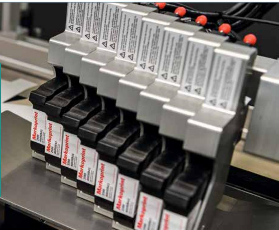
Wenn die Produktverpackung über zahlreiche verschiedene Linien erfolgt, macht es unter Umständen Sinn, die Kennzeichnung der Faltschachteln im Vorfeld in einer speziellen Anlage zu bündeln. Für einen polnischen Hersteller von Fahrzeugfiltern hat die Kraus Maschinenbau GmbH aus Spaichingen daher die sogenannte FK Codingline entwickelt. Die Etikettier- und Drucktechnik der Linie stammt vom Kennzeichnungsanbieter Bluhm Systeme GmbH aus Rheinbreitbach.
