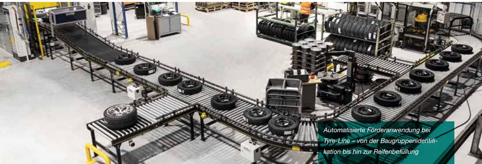
Automatisierte Förderanwendung bei Tyre-Line – von der Baugruppenidentifikation bis hin zur Reifenbefüllung
