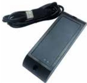
Die Übertragung der Daten erfolgt wahlweise über nachfolgende Schnittstellen: RS232, RS485, Wiegand, Clock/Data oder USB. Im USB HID Modus können Benutzerdaten von den unterstützten Transpondern als Tastaturemulation abgerufen werden. Die Zugriffsberechtigungen können mit Hilfe des Montageleser Mini eindeutig zugeordnet werden, wodurch eine missbräuchliche Nutzung der Geräte und Systeme ausgeschlossen ist.
