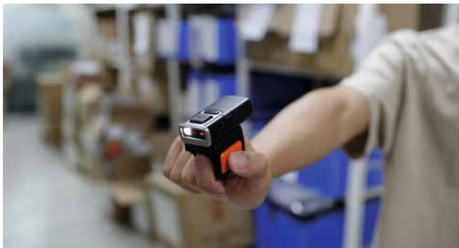
Die Besonderheit liegt im Design des Ringscanners: Die durchdachte Bauweise erlaubt die Bedienung des PM5 sowohl fürs Links- als auch Rechtshänder. Per Knopfdruck löst sich der obere Scanneraufsatz vom Trigger und kann nun einfach um 180 Grad gedreht wieder aufgesetzt werden. Zusätz-
