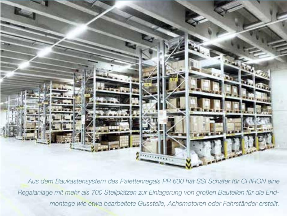
*Aus dem Baukastensystem des Palettenregals PR 600 hat SSI Schäfer für CHIRON eine Regalanlage mit mehr als 700 Stellplätzen zur Einlagerung von großen Bauteilen für die Endmontage wie etwa bearbeitete Gussteile, Achsmotoren oder Fahrständer erstellt.*
