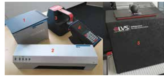
Abb. 2: Abbildungen der Geräte: 1- VeriCube; 2-PC-Scan LD4; 3-Axicon 1500; 4-Scan-Check; 5- LVS 9510
