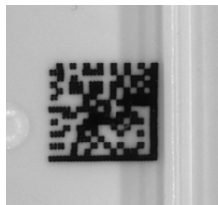
Bild 1: In diesem Fall wurde per Tintenstrahl-druck (Punktstruktur) auf einem weißen Kunststoffmaterial ein Data Matrix Code aufgebracht. An den Rändern der Matrixzellen und insbesondere bei den weißen Matrixzellen, die von schwarzen umgeben sind, sind Schattenränder zu erkennen.
