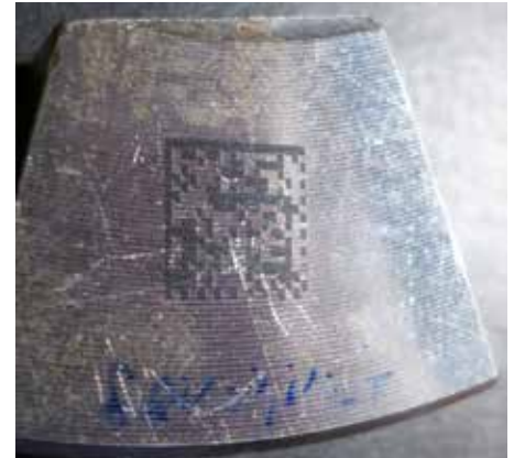
Bild 10/11: Auf einem spiegelnden Metall, auf dem zudem noch die Riefen der Bearbeitung zu sehen sind, wurde ein Code gelasert. Die Ausleuchtung ist in beiden Fällen ungeeignet. Es muss eine sehr diffuse (z.B. DOME) Beleuchtung benutzt werden. Wenn dann die Riefen sichtbar bleiben und stören, muss zuerst das Material mit dem Laser geschichtet werden und dann muss der Code geschrieben werden.
