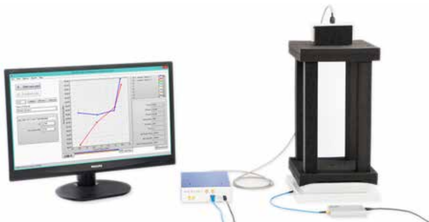
Performanztestergebnisse und Testsetup mit Tag Emulation nach ISO/IEC 18046-2 / RAIN RFID
