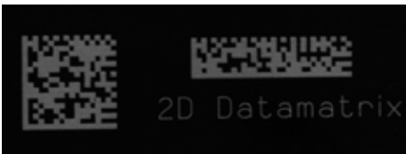
Bild 5: Auf einem schwarzem Kunststoffmaterial wurden Codes gelasert. Der Laser erzeugt entweder einen Farbumschlag im Material oder schäumt das Material leicht weiß auf. In diesem Fall ist der Kontrast so gut, dass annähernd die Druckqualität eines Codes auf einem Etikett erzielt wird.
