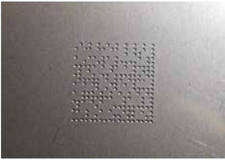
Bild 4: Dies entspricht Bild 3. Die Aufnahme ist aber völlig anders erfolgt. Die ungleichmäßige Ausleuchtung und das sehr unterschiedlich Erscheinungsbild der Matrixzellen wird die Lesefähigkeit in so einem Fall stark erschweren.
