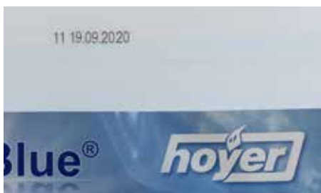
Damit die Drucke auf der Kunststoffoberfläche haften, kommt lösungsmittelhaltige Tinte zum Einsatz.
