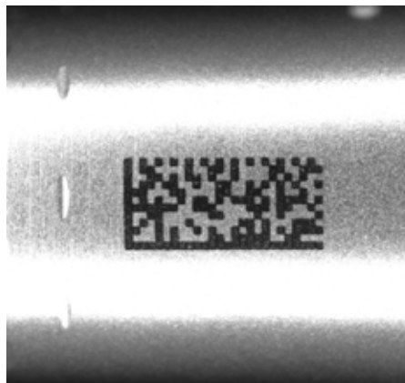
Bild 7/8: In diesem Fall sind Codes auf einer grauen, leicht strukturierten Metalloberfläche gelasert. Das funktioniert recht gut. Zu beachten ist dabei die Beleuchtung. Diese so diffus sein, dass über die Rundung keine Spiegelung entsteht. Bei Bild 8 ist erkennbar, dass die Anforderung nur noch bedingt eingehalten wird.
