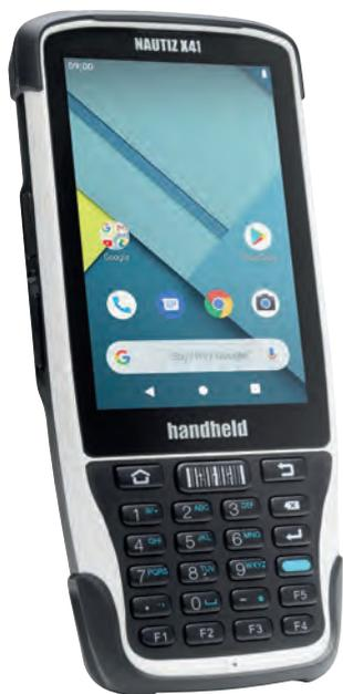
**Viele arbeiten mit Touchscreen, aber einige Anwendungen erfordern immer noch einen echten Ziffernblock. Der robuste Nautiz X41 bietet beides. Unter leistungsstarkem Android 9.0 können Sie zwischen einem 1D-Scanner oder einem 2D-Imager wählen und haben zudem eine 8-Megapixel-Kamera, NFC und großzügigem Speicher. Dieser robuste Handheld erfasst Daten über den kapazitiven Touchscreen oder physische Tasten.**
