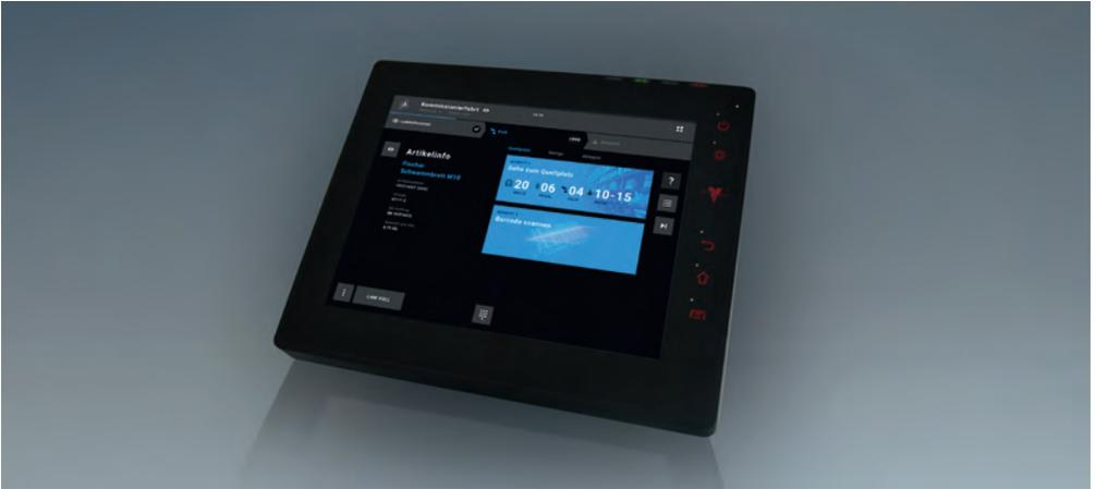
Das pro-V-pad Classic Android überzeugt durch sein großflächiges Display, die flache, sehr leichte, aber robuste Bauweise sowie flexible Einsatzmöglichkeiten. Der belastbare Industrie-PC ist umfangreich ausgestattet und setzt mit seinem Android 5.1.1 Betriebssystem und dem Herzstück – einem leistungsstarken Snapdragon 600 Quad-Core Prozessor neue Maßstäbe im Bereich IPCs.
