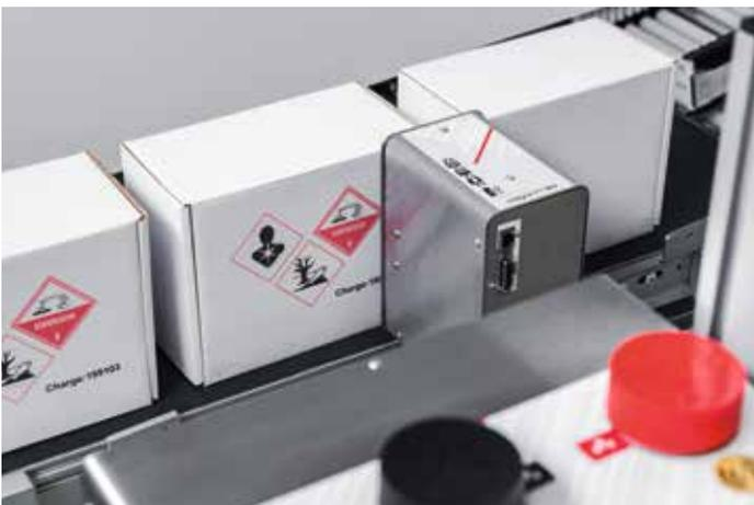
Ergänzend zum Piezo-Tintenstrahldrucker integra PP 108 zum Bedrucken von saugfähigen Primär- und Sekundärverpackungen hat Bluhm Systeme den Zweifarben-Drucker integra PP 108 bicolor auf den Markt gebracht. Das Besondere an dem System: Exklusiv ausgestattet mit innovativem Seiko-Druckkopf druckt er mit zwei Farben, aber nur einem Druckkopf. Detailgetreu kann integra PP 108 bicolor so z.B. zweifarbige Unternehmenslogos oder Warnsymbole wiedergeben.
