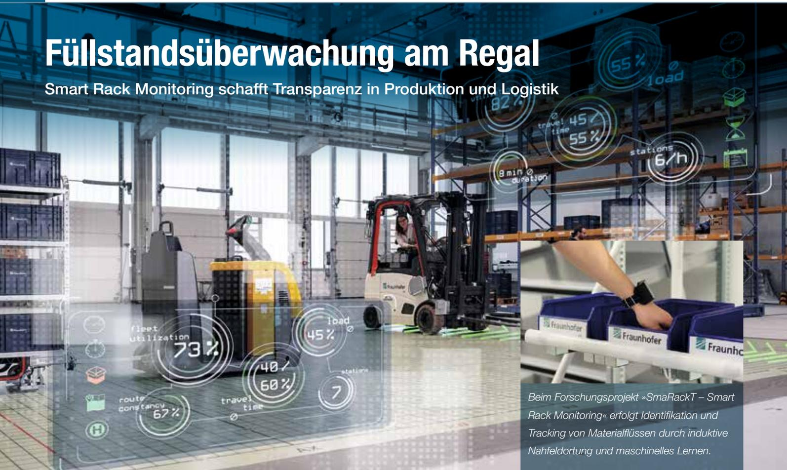
Beim Forschungsprojekt »SmaRackT – Smart Rack Monitoring« erfolgt Identifikation und Tracking von Materialflüssen durch induktive Nahfeldortung und maschinelles Lernen.
