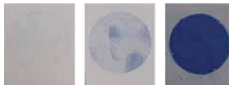
Abb. 6: Der Methylenblau Test zeigt die Dichtigkeit der Silikonschicht auf Linerless Papier. Eine sehr gute Silikonabdeckung erlaubt keinen Kontakt des Methylenblau mit den Papierfasern und das Papier färbt sich nicht.
