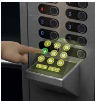
Die Technik dahinter kombiniert einen Infrarotsensor von Neosens in Kombination mit einem optischen 3D-Element aus Japan. Überall dort, wo ein Videosignal und ein USB-Anschluss für den Touchscreen zur Verfügung stehen, kann das holografische Terminal nachgerüstet werden. Weiter führende Informationen finden sich auf der Website von HY-LINE, wo auch ein persönlicher Vorführtermin vereinbart werden kann. Natürlich ohne Berührung.
