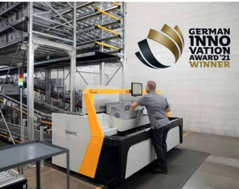
Es ist speziell auf die Anforderungen von Händlern mit hohen Durchsatzraten zugeschnitten und stellt Online-Bestellungen innerhalb von einer Stunde vollautomatisch zur Abholung oder Auslieferung zusammen.
