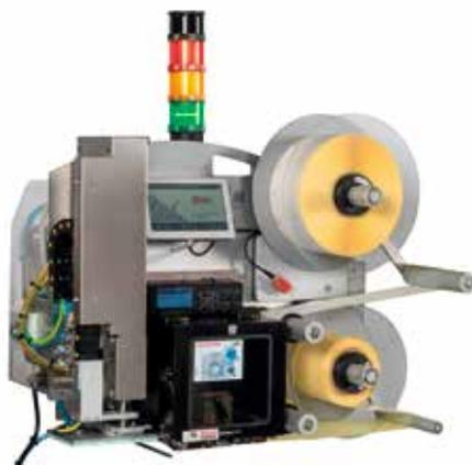
dung anpassbar. Druckmodule aller führenden Hersteller können integriert und bei Bedarf auch schnell gegen ein anderes ausgetauscht werden. Abhängig vom jeweiligen Druckmodul druckt Legi-Air 4050 E Etiketten mit Daten in 200 bis 600 dpi Auflösung. Für das Aufbringen der Etiketten stehen zahl-
