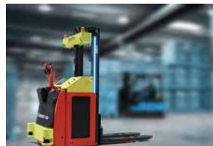
identpro CARRI bewegen bis zu 2 Tonnen mit 2 m/s. Bis zu 1,6 Tonnen werden 2,8 Meter gehoben. CARRI Fahrzeuge nehmen beliebig in der Fläche abgestellte Paletten auf, ohne Gestelle. Induktives Laden ermöglicht 24/7-Einsatz ohne Mitarbeiter eingriff. Die Lokalisierung erfolgt Kontur-basiert, ohne Eingriffe in die Lagerstruktur. Fahrwege werden durch den Anwender bequem im Browser verwaltet.
