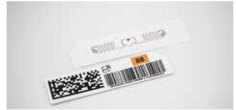
auch die hohen Hygieneanforderungen der Lebensmittel- und Pharmaindustrie und sind industrieweit für die Fleischbehälterkennzeichnung GS1-zertifiziert. Das einschichtige Etikett mit integriertem Barcode, der gedruckten RFID-Antenne sowie dem montierten RFID-Chip, wird im Spritzgussverfahren untrennbar mit dem Ladungsträger verbunden. So wird der RFID-Tag ein integraler Bestandteil des Ladungsträgers und damit manipulationssicher.
