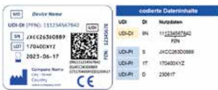
Abb. 2: Medizinprodukt UDI-konform markiert mit PPN11 und eingebetteter PZN (Quelle: IFA Coding System, Spezifikation Unique Device Identification (UDI), Beispiel 7)
