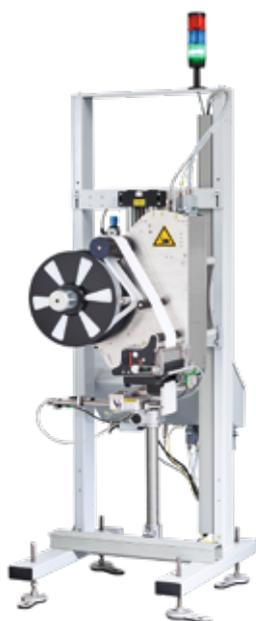
*Das neue, vollautomatische Etikettiersystem Logomatic 410 Linerless von Logopak ermöglicht es, Sekundär- und Versandverpackungen abfallfrei, flexibel und kostengünstig zu kennzeichnen.*
