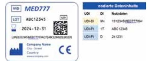
Abb. 3: Medizinprodukt UDI-konform markiert mit HPC und eingebetteter Hersteller-Referenz „MED777“ (Quelle: IFA Coding System, Spezifikation Unique Device Identification (UDI), Beispiel 9)
