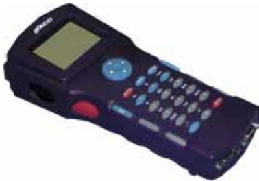
Das M100 beinhaltet eine integrierte Antenne, Funkmodem SFM95, 433 MHz / 500 mW, LCD-Display grafikfähig 240 x 160 Pixel (CGA) beleuchtet, integrierter Scanner, Kautschuktastatur mit 22 Tasten, Speicher (2 MB Hauptspeicher, 1 MB-RAM-Floppy, 2MB Flash on Board), Schnittstellen (2xRS232, 1x Diagnoseport, 1x Infrarotschnittstelle) und das Betriebssystem: ROM-DOS.
