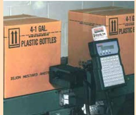
Einstieg in die High-Resolution-Piezo-Inkjet-Technologie zum direkten Bedrucken von Kartons.
