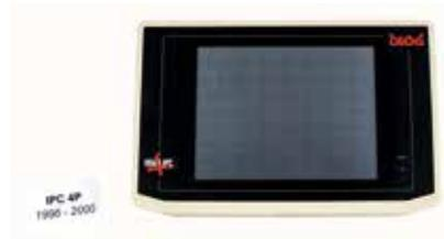
Der DNeT IPC 4 wurde als Multifunktionsterminal für Aufgaben in der Produktion oder der Logistik geschaffen. Durch den Einsatz neuester Technologien für Display und Touch-Screen verbindet der DNeT IPC 4 eine hervorragende Bildqualität mit einfacher Bedienbarkeit. Die Integration von Interface-Karten ist ebenso gewährleistet wie der Anschluß eines Barcode-Scanners oder einer Tastatur.
