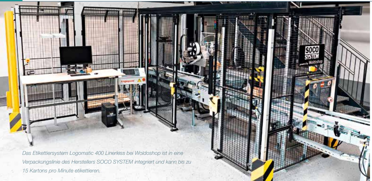
Das Etikettiersystem Logomatic 400 Linerless bei Woldoshop ist in eine Verpackungslinie des Herstellers SOCO SYSTEM integriert und kann bis zu 15 Kartons pro Minute etikettieren.
