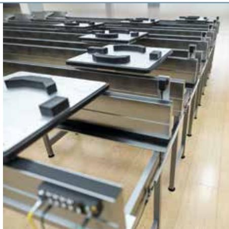
Jede Förderlinie ist am Ende mit einem busfähigen Scheib-Lese-Kopf ausgerüstet, einfach in Linientopologie mit T-Verteilern installiert
