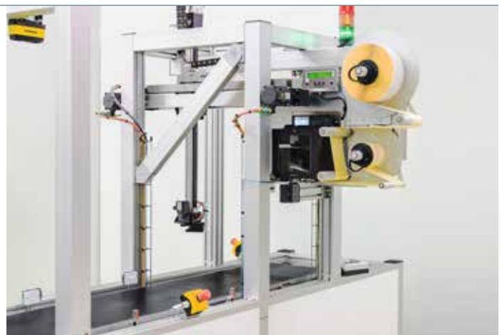
minimal mechanisch belastet. So eignet sich der Legi-Flex 6100 auch zur Kennzeichnung besonders sensibler Produkte. Er verarbeitet Etikettenmaterial mit einer Breite von vier Zoll bzw. 100 mm sowie standardisierte DHL-, Hermes-, UPS-Versandetiketten.
