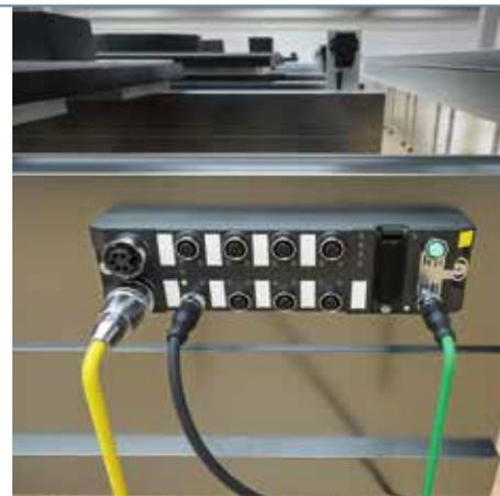
Pro RFID-Kanal lassen sich bis zu 32 busfähige Scheib-Lese-Köpfe anbinden, bei vier Kanälen also maximal 128 Stück pro Interface
