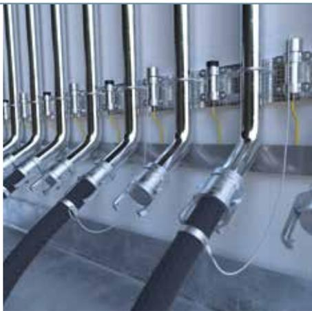
Der RFID-Reader TNR42/TC-EX erfasst im Ex-Bereich die in den Kappen eingelassenen RFID-Datenträger und gewährleistet so eine sichere Produktion und Nachverfolgbarkeit
