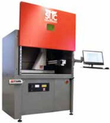
Auf der Motek 2021 hat SIC Marking eine Programmiererweiterung der Beschriftungslaser für größere Bauteile vorstellen. Ein Portalsystem im Arbeitsraum macht die XXL-Box zur Multi-Achs-Maschine. So kann der Anwender z.B. Werkzeuge an mehreren
