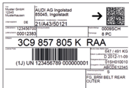
Abb. 5: EDI-Marke auf dem Global Transport Label (GTL) für Zulieferung an die Werke der VW AG. (Quelle: Volkswagen_GTL_V4.1.5_DE, Abb. 13)
