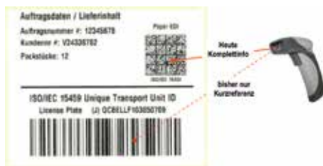
Abb. 1: Transportetikett nach ISO/IEC 15459/EN1573) bisher versehen mit Code 128 mit der Transportreferenz (License Plate), heute mit DataMatrix mit dem kompletten Transportinhalt
