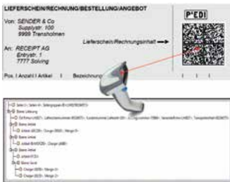
Abb. 9: Scannen einer EDI-Marke und Darstellung der Datenhierarchie vor Überstellen in die Applikation des Verarbeitungssystems (unterer Bildteil)
