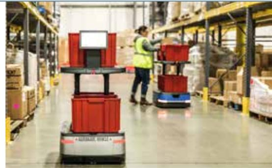
senten erleben, wie Chuck funktioniert und als Basis für die End-to-End-Fulfillment-Lösung von 6 River Systems die Produktivität steigert. In Kombination mit den neuen Mobile Sort und Packout macht der kollaborative Roboter von 6 River Systems die gesamte Intralogistik schneller – vom Wareneingang bis zum Versand am Wareneingang.
