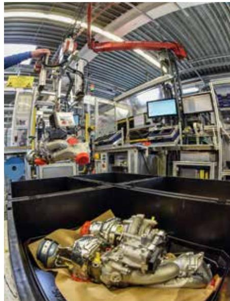
*Mit dem Kran werden die Turbolader nach der letzten Montagestation vom Werker in die Trays der 4 Boxen positioniert und abgelegt.*
