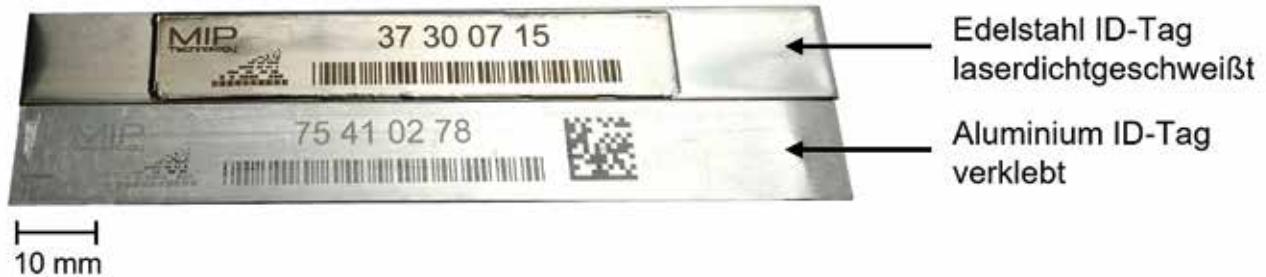
Abb. 1: Beispiele eines Aluminium- und Edelstahl ID-Tags, ausgestattet mit optischen Codes und einer menschenlesbaren ID
