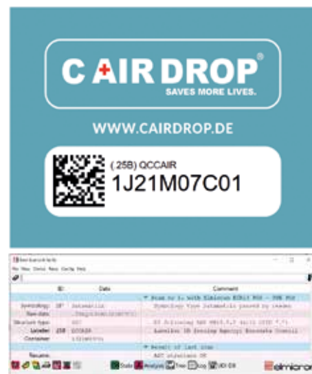
Abb. 3: Eindeutiger Container-Code für die Rettungsbox zur Notfallversorgung in KB-WEB-Syntax DIN 16598 + Scan-Analyse
