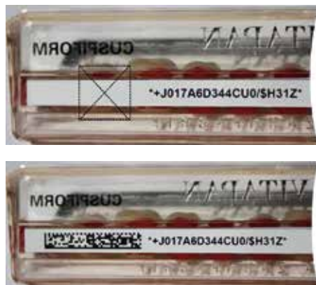
Abb. 1: Ein Medizinprodukt mit schmaler Fläche für einen Barcode soll einen UDI-Code erhalten, eine quadratische Data Matrix wäre zu groß, aber ein DMRE passt auf den Platz. Der Beispielcode trägt eine UDI-DI+DI-PI gemäß MDR.
