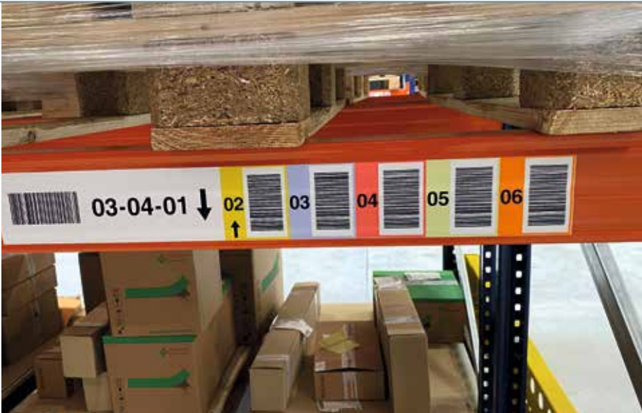
An der jeweils untersten Traverse der Hochregale hat das ONK-Team mehrfarbige Man-down-Etiketten angebracht.
