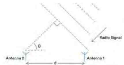
Abb. 8: Verwendung der Phasendifferenz zur Ableitung des Einfallswinkels (Angle of Arrival)
