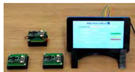
Abb. 3: Realisierte Funktionsmuster für die Praxiserprobung (Sensorschaltungen und Anzeige- / Auswertemodul)
