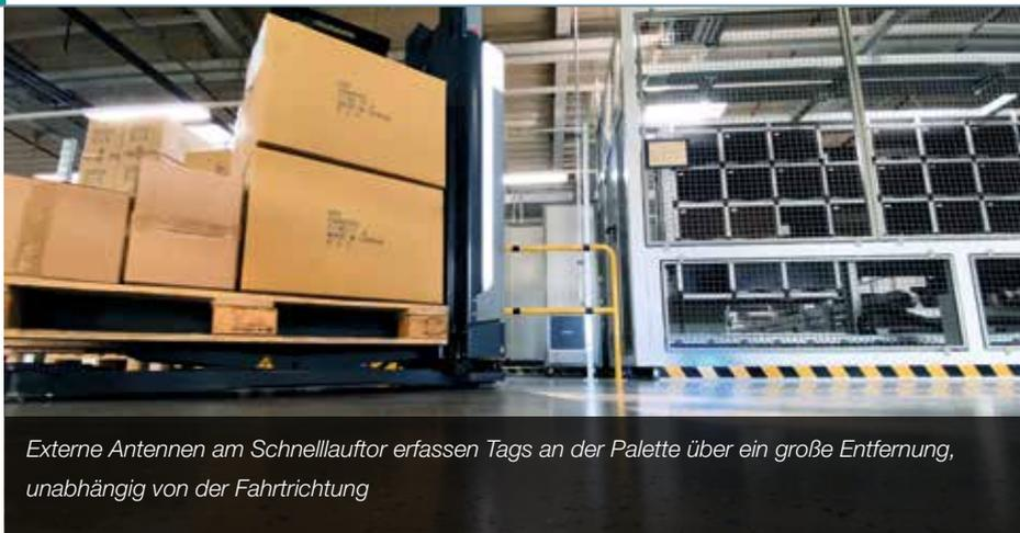
*Externe Antennen am Schnelllauftor erfassen Tags an der Palette über eine große Entfernung, unabhängig von der Fahrtrichtung*
