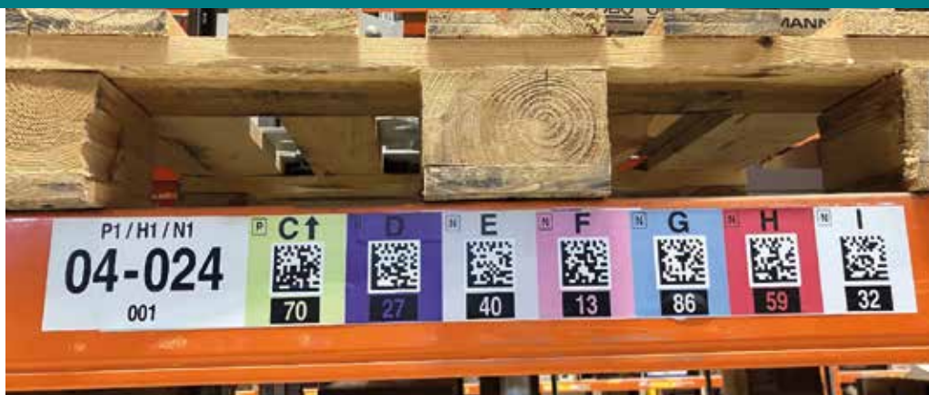
Die farbigen Mehrebenen-/Man-down-Etiketten an der untersten Traverse bilden jeweils den darunter sowie alle direkt darüber liegenden Stellplätze ab.
