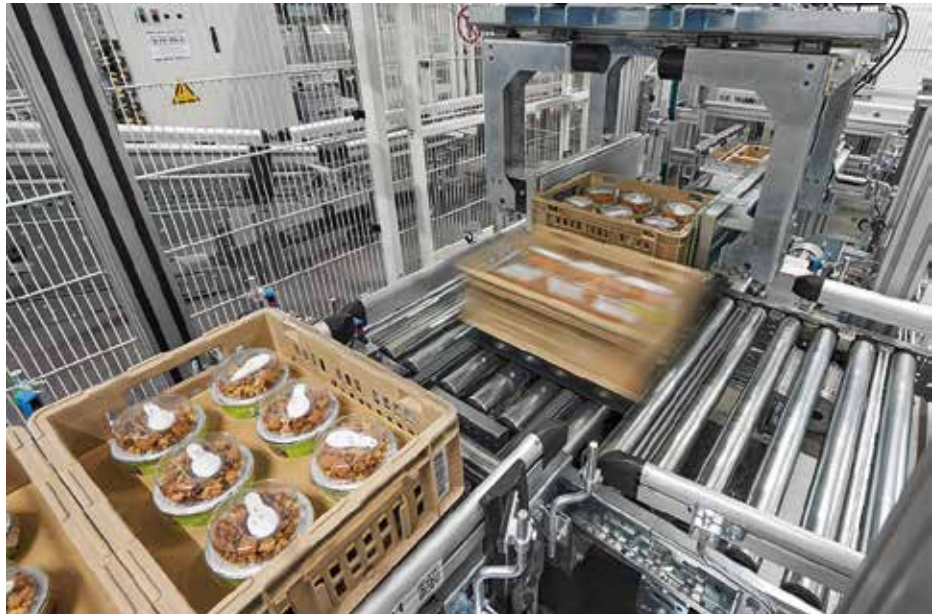
Kommissionierung von Convenience-Artikeln mit der WITRON-ATS-Lösung im Brownfield-Konzept von MIGROS.
