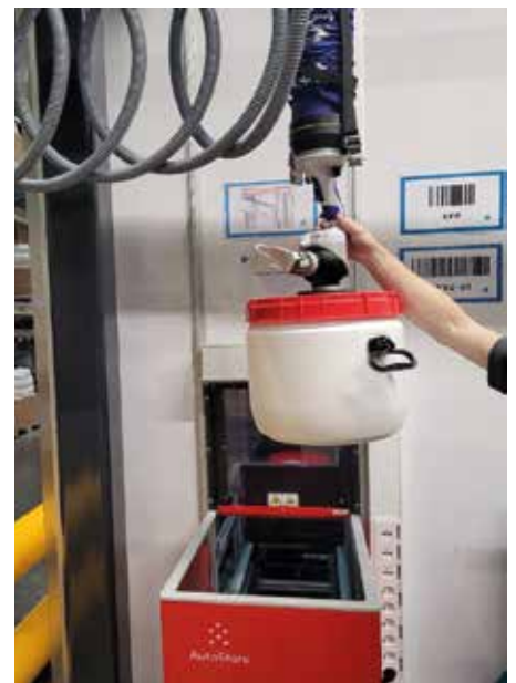
Pneumatische Hebevorrichtung zur Einbringung der Ware in den AutoStore
