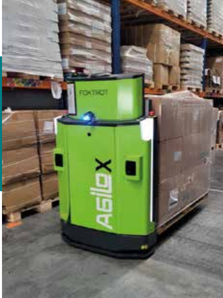
Agilox - Intelligentes Fahrerloses Transportsystem (Quelle: Mann & Schröder Cosmetics)
