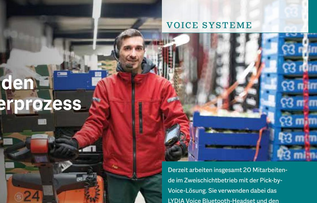
Derzeit arbeiten insgesamt 20 Mitarbeitende im Zweischichtbetrieb mit der Pick-by-Voice-Lösung. Sie verwenden dabei das LYDIA Voice Bluetooth-Headset und den mobilen Sprachcomputer VOXTER, der am Gürtel getragen wird.
