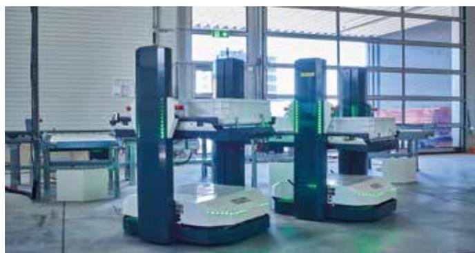
wird es einen flexibel nutzbaren Arbeitsplatz für Warenein- und -ausgang geben. Die Produktionsversorgung wird just-in-time und just-in-sequence über die autonomen mobilen Roboter Open Shuttles sowie eine integrierte Fördertechnik erfolgen. Zentrales Steuerungselement der neuen Automatisierungslösung wird das Softwarepaket KiSoft von KNAPP sein.
