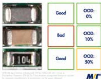
Mit diesem neuen HALCON-Feature lässt sich unvorhergesehenes Verhalten durch falsche Klassifizierungen in der Produktion einfach erkennen und entsprechende Maßnahmen, wie z.B. ein Maschinenstopp, können zielgerichtet und effizient eingeleitet werden. Das neue Deep-Learning-Feature „Out of Distribution Detection (OOD)“ zeigt den Nutzern an, wenn ein Objekt klassifiziert wird, das nicht in den Trainingsdaten enthalten war.
