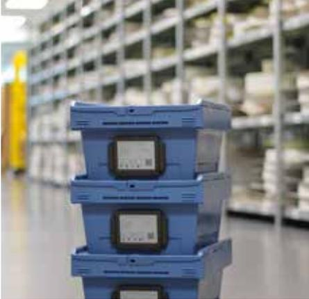
Smart Label ermöglichen eine dynamische Beschriftung intralogistischer Prozesse. Das batterielose Faubel-Logistics Label mit E-Paper-Display und RFID-Tag ist optimal auf die Bedürfnisse der Logistikbranche angepasst. Vor allem für wiederverwendbare Behälter in Kanban- und Closed-Loop-Prozessen eignet sich diese papierlose und flexible Kennzeichnung.
