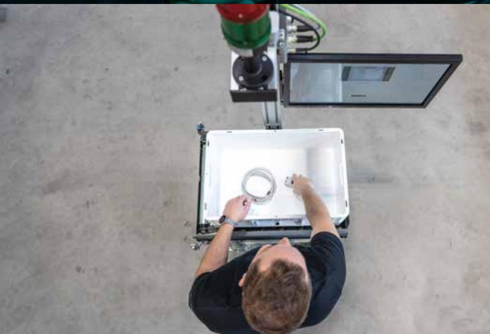
tem analysiert, das Abweichungen sofort erkennt und klassifiziert. Am Montage-Arbeitsplatz leitet ivii iriis Mitarbeiter Schritt-für-Schritt durch den Arbeitsprozess, gibt Feedback in Echtzeit, falls ein Korrekturbedarf besteht, und verhindert so, dass fehlerhafte Bauteile oder fehlerhafte Produkte den Arbeitsplatz verlassen. Entlang der Förderstrecke kontrolliert ivii iriis jeden zuvor defi-
